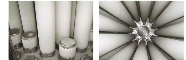
残液濾過工程では、プリコート層が剥離することなくケーシング内の残液だけを回収することができます。
